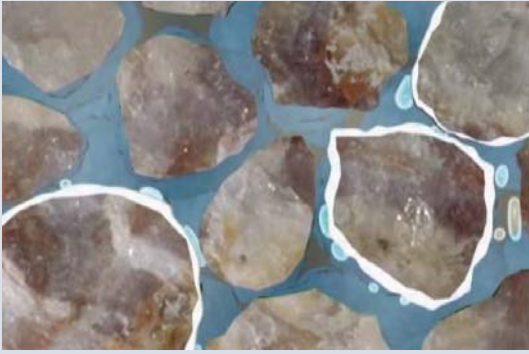
Figuur 2 Superkritisch CO 2 dat naar boven migreert (lichtblauwe belletjes) lost op en reageert met het gesteente waardoor carbonaten neerslaan op de randen van de korrels (wit).
