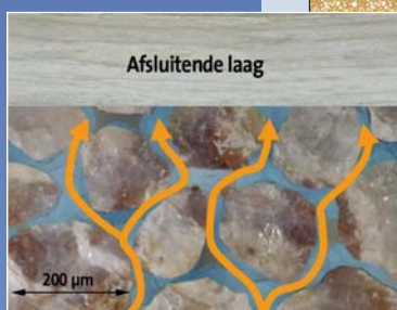
Figuur 1 Het geïnjecteerde CO 2 is lichter dan water zodat het de neiging heeft opwaarts te stromen en wordt gestopt door bovenliggende ondoorlaatbare gesteenten.
