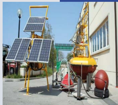
Figuur 2 Bewakingsboei met zonnepanelen voor energievoorziening, drijvers en een apparaat voor het bemonsteren van gas op de zeebodem.
